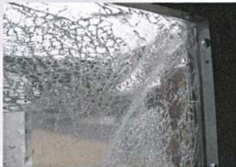
Nach dem Sprengtest des Fraunhofer Instituts: Die Folie hält die Glassplitter zusammen und verhindert den Splitterflug. Bild: HAVERKAMP
