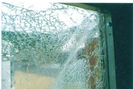
Die vierlagige, kaltlamierte Folie verfügt über eine besondere Faserstruktur und hat bisher als einzige Folie den Stoßrohr-Test gemäß DIN EN 13541 ER 1 (NS) bestanden. Das Foto zeigt die Folie nach einem solchen Test.
