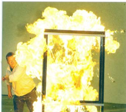
Molotow-Test mit der Hochsicherheitsfolie „Profilon ER1“
