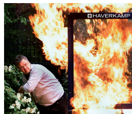
Die Brandüberschlagshemmung der PROFILON® AX A1 im Test.
