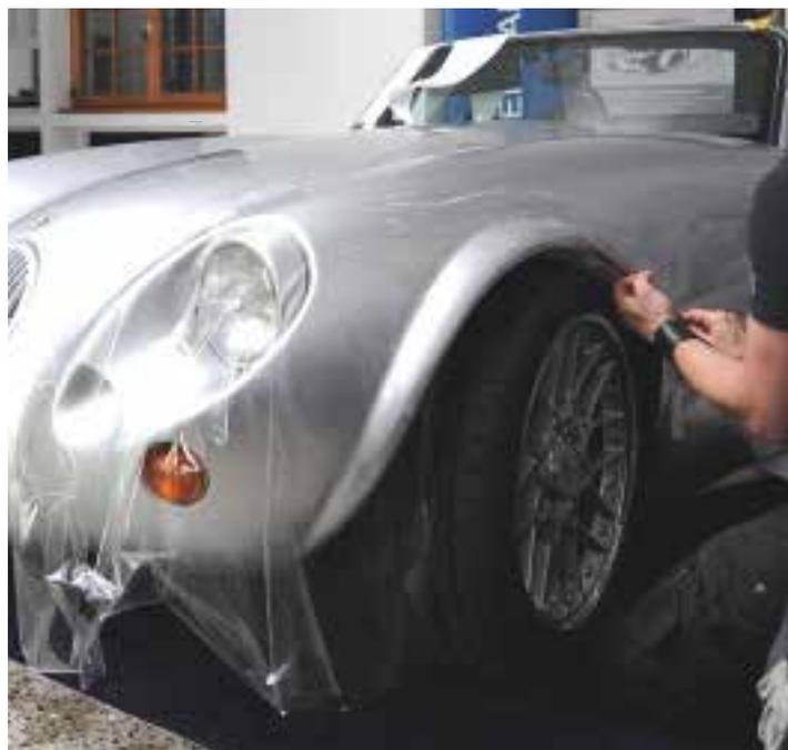
HAVERKAMP Lackschutzfolien sind spezielle, hochbelastbare Folien zum Schutz von Lackoberflächen bei Fahrzeugen aller Art. Sämtliche lackierte Autoteile können nachträglich mit HAVERKAMP Lackschutzfilmen vor Kratzern, Lackrissen und Steinschlag geschützt werden.
